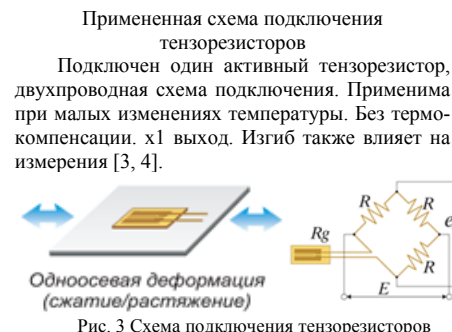
Рис. 3 Схема подключения тензорезисторов
