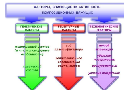
Рис. 1. Факторы, влияющие на активность композиционных вяжущих
